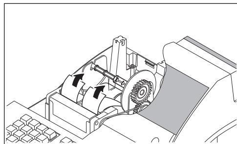
5. För kvittoremsan genom hålet i printerkåpan och sätt därefter tillbaka kåpan.
